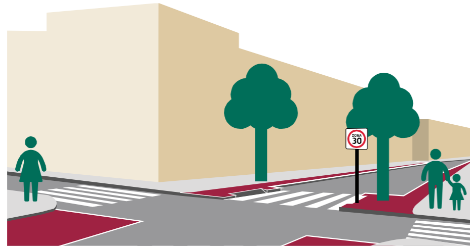
Figura 111.- Portal de acceso a zona de tránsito calmado [1] [2]
